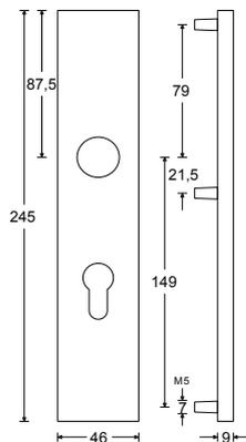
\*\*\* Bohr- bzw. Fräsmaß für Drückerloch  $\varnothing$  25 mm beachten!
